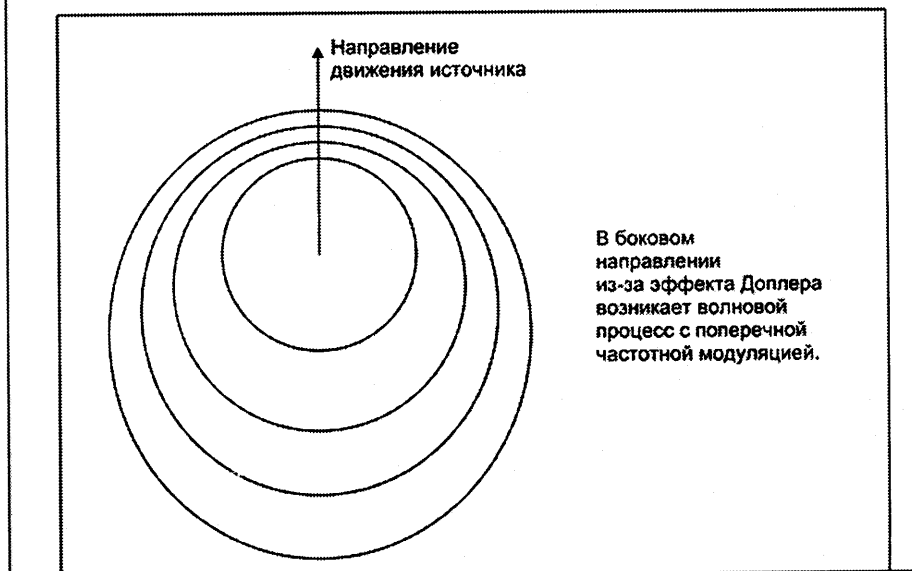
Рис. 18. Возникновение поперечной частотной модуляции при движении источника волн.
